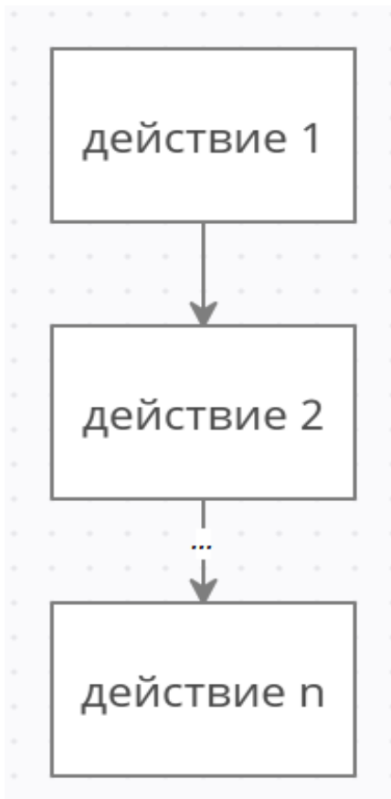
Рис. 107. Блок-схема линейного алгоритма
