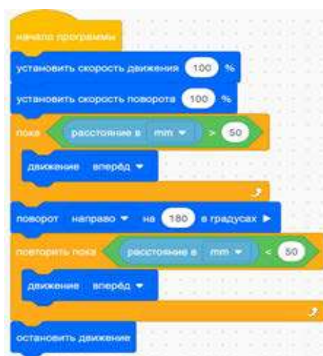
Рис. 26. Отличия циклов в VEX VR
