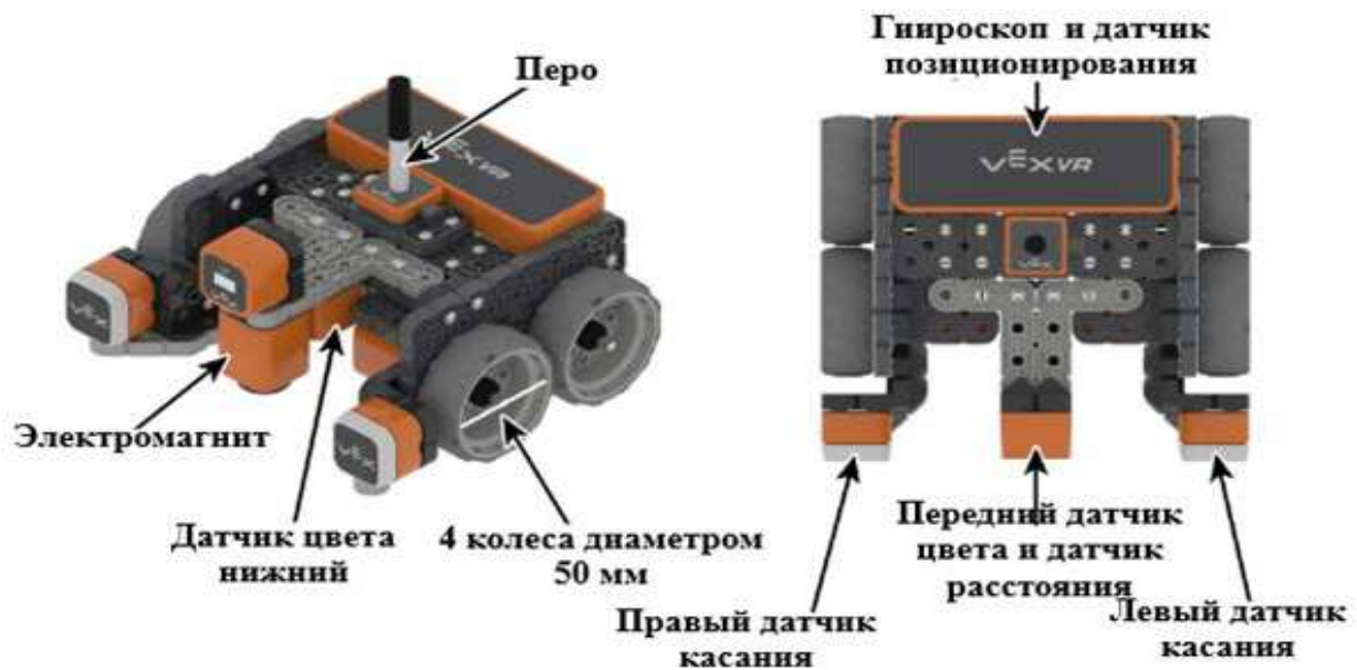
Рис. 7. Конфигурация датчиков робота
